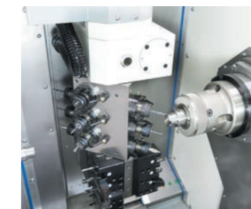
Фрезерная обработка на противощпинделе с применением оси B
