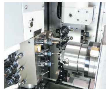
Фрезерная обработка детали в протившпинделе
